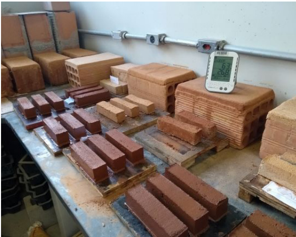
03 Prismatische Proben und Putzproben auf Lehmsteinen und Ziegelsteinen im Labor
