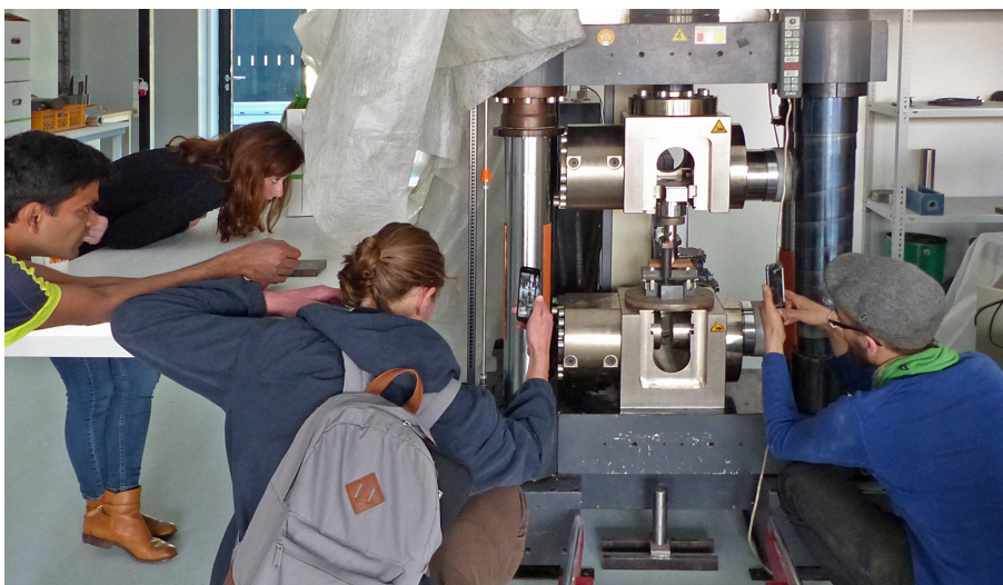
04 Selbst entwickelte Lehmsteine auf dem Prüfstand im Labor: Kompetenzzentrum Bau MV der Hochschule Wismar
