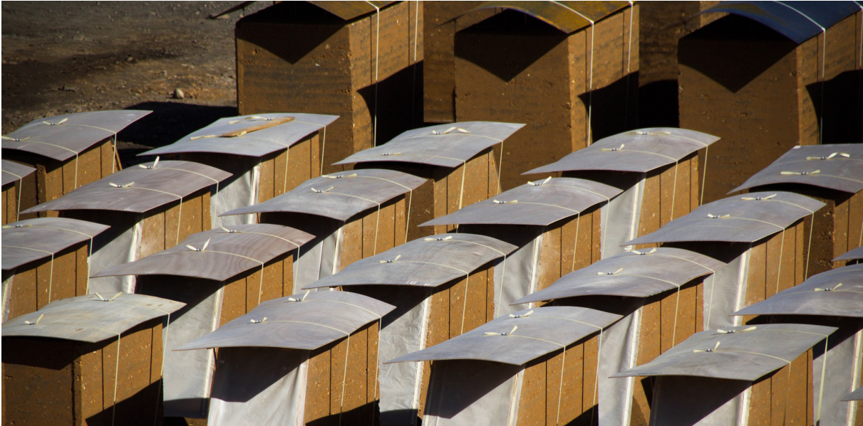
09 Lagerung und Trocknung der Lehmblöcke (© M. Valcarce)
