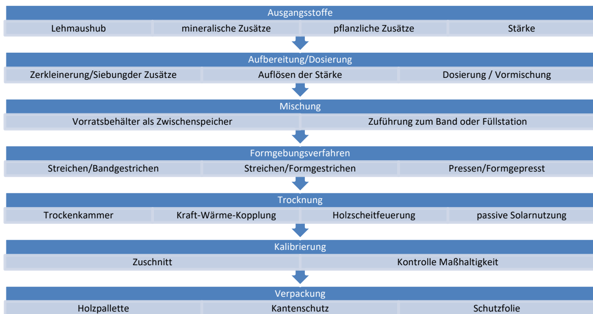
Bild 4.1 Allgemeines Herstellungsschema für Lehmplatten
